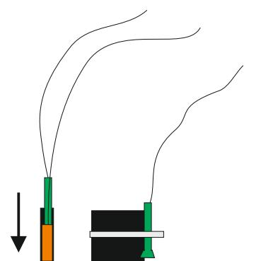
В погружную гильзу вначале опускается датчик центрального отопления (датчик ЦО), а за ним датчик термозащиты (термик). Как вариант, допускается установка датчика термозащиты на патрубке подающего трубопровода котла (до гайки подключения), при этом, прижатие его к патрубку должно выполняться металлическим хомутом. Добавление каких-либо жидкостей в погружную гильзу запрещено!
